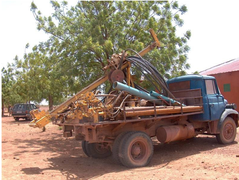
La Ingersol Rand ... installée sur un camion
