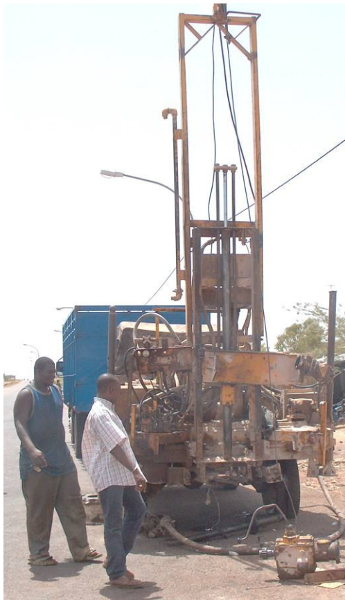
Dépannage d'une sondeuse au bord de la route à la sortie de Ouagadougou
