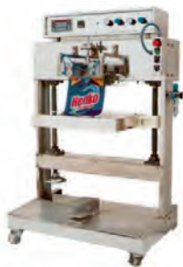
Figure 4.2. Equipement pour l'emballage sous azote
